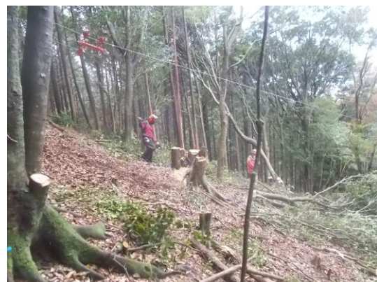
写真2 軽架線による広葉樹の掛かり木処理
