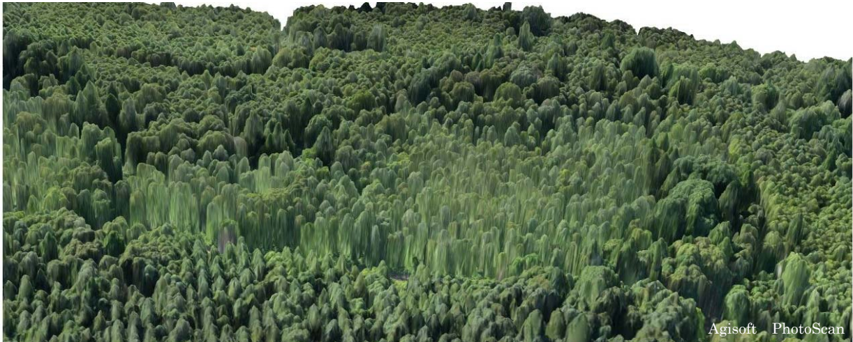
図1. 数百枚の空撮画像から構築した雨龍研究林の森林3Dモデル
