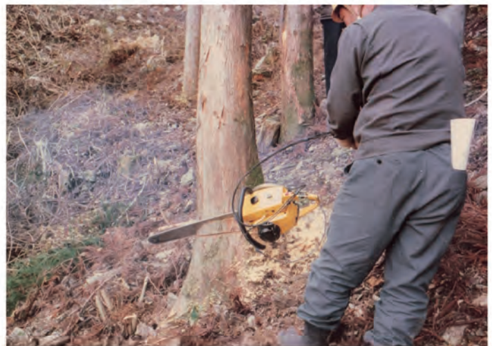
高知大学演習林にて、高知営林局 (当時) が考案したリモコン操作式 チェーンソーの実演 [1977 (昭和52) 年]
